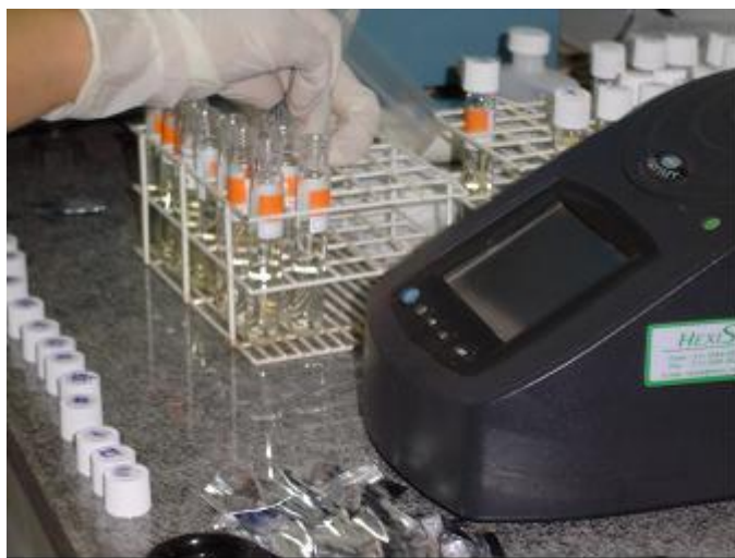
Figura 2: Realização da análise de cor em espectrofotômetro DR 2500 HACH.
